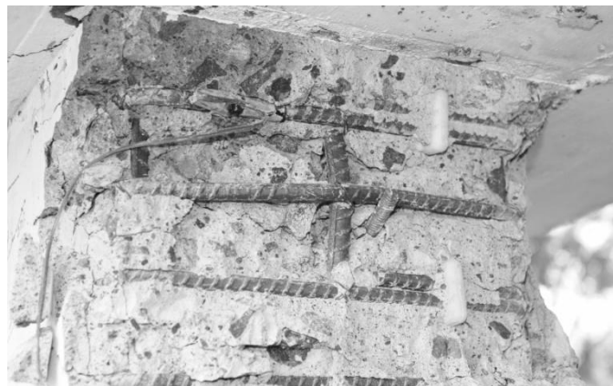
Gambar 13. Foto Benda Uji pada Akhir Pengujian dengan Pen-binder dari Material Plastik
